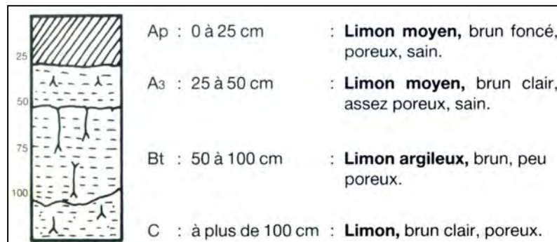
Figure 13 : Coupe de sol-type au niveau du site d'étude (Les Sols de Haute-Normandie, 1988)
